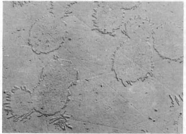
Bild 9. Elektronenmikroskopische Aufnahmen (Replika) von Glas 3028 ( 1\text{Na}_2\text{O}\cdot 2\text{TiO}_2\cdot 6\text{SiO}_2 ). Wärmebehandlung der Proben.
