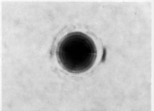
Bild 16. Lichtmikroskopische Aufnahmen von Glas 3042 ( 1\text{Na}_2\text{O} \cdot 3\text{TiO}_2 \cdot 8\text{SiO}_2 ). Wärmebehandlung der Probe: 740^\circ\text{C} , 2 h.
